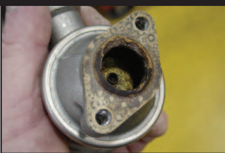
Figura 2: ¿Cómo puede tener esta válvula tanta corrosión? Y por qué es el flujo actual del motor mas elevado sin la restricción
