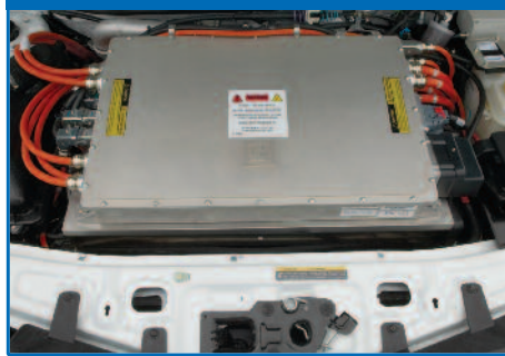
Células de combustible de hidrógeno GM y la plomería relacionada.
