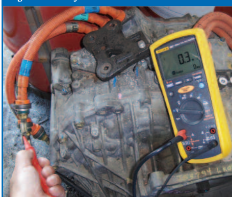
Figura 4: Transeje Híbrido con cuerdas cortas de MG
